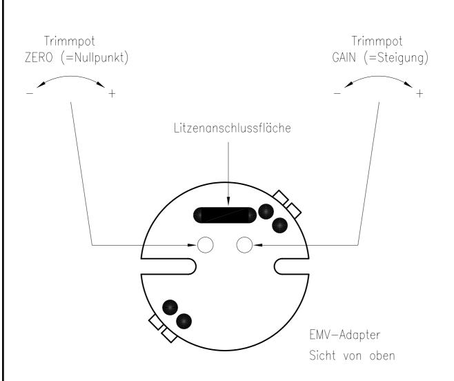
Justieren von Nullpunkt und Steigung bei 0-20 mA, 4-20 mA und Spannungsausgang
